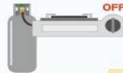
瓦斯更換後進行測漏，確認無洩漏現象
