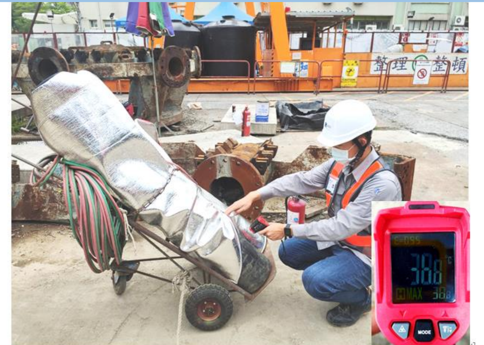
項次：2。照片說明：安裝隔熱墊後量測鋼瓶表面溫度所得溫度值為36.8度。
