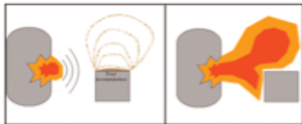
圖一 初始爆炸及二次爆炸示意圖。
