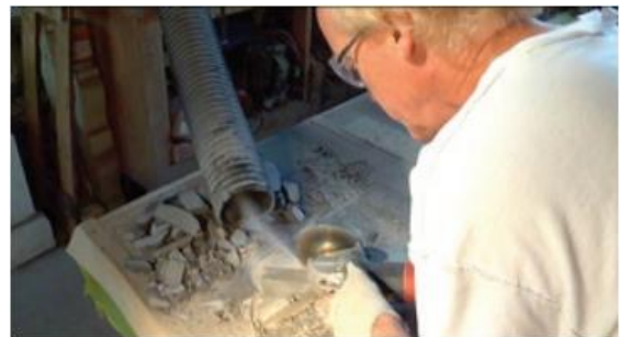
圖二：在磨石時，工人使用局部排氣通風清除矽成，減少接觸。
