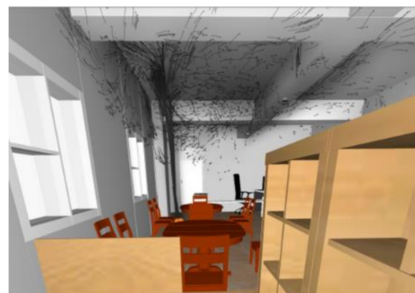
圖6住警器作動時煙霧蓄積情形
