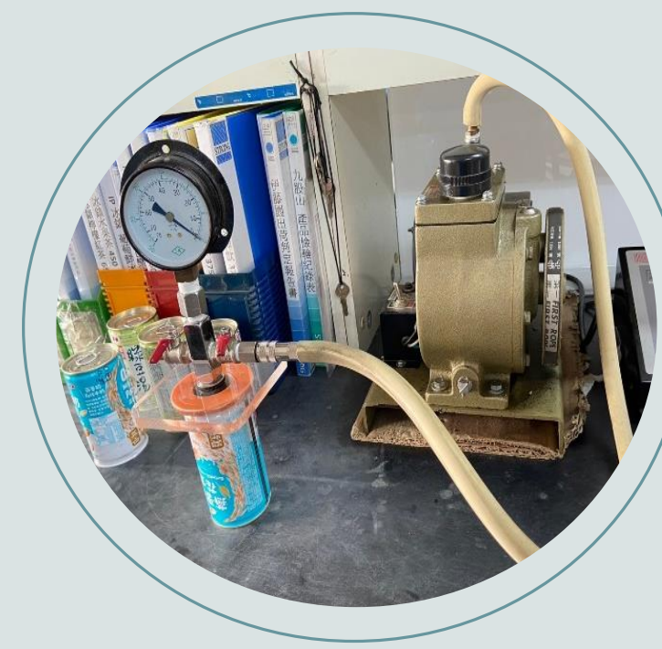
◇ 真空檢漏試驗(空罐)
