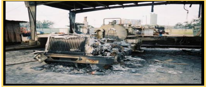
圖二 一場火災造成 3 人死亡，4 人受傷。失控的柴油內燃發動機[2]。
