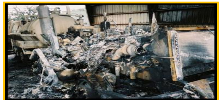
圖三 露天集塵室產生致命火災的點火源是兩台真空卡車柴油發動機其中之一[2]。
