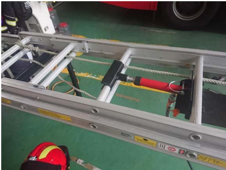
圖1 梯階強度測試
