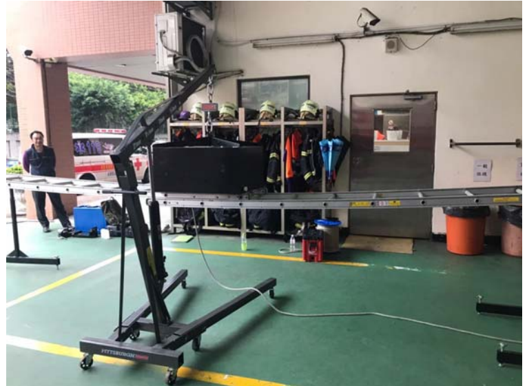
圖2 梯子彎曲變形量測試
