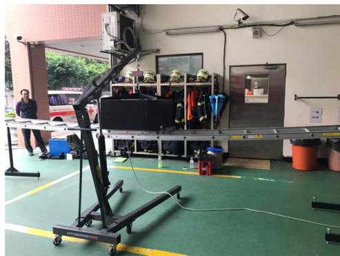
圖2 水平彎曲變形量測試
